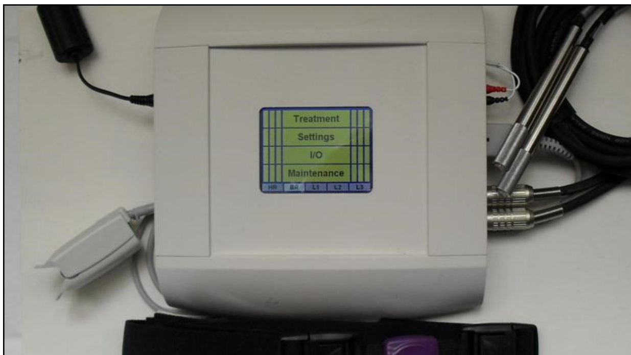
Рисунок 3. Программно-аппаратное устройство биоуправляемой лазерной терапии. 1- датчик пульса, 2- датчик дыхания, 3- лазерные диоды.
