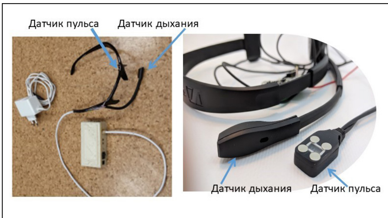
Рисунок 4. Программно-аппаратные устройства биосинхронизации и биомодуляции на основе очковой оправы или наушников
